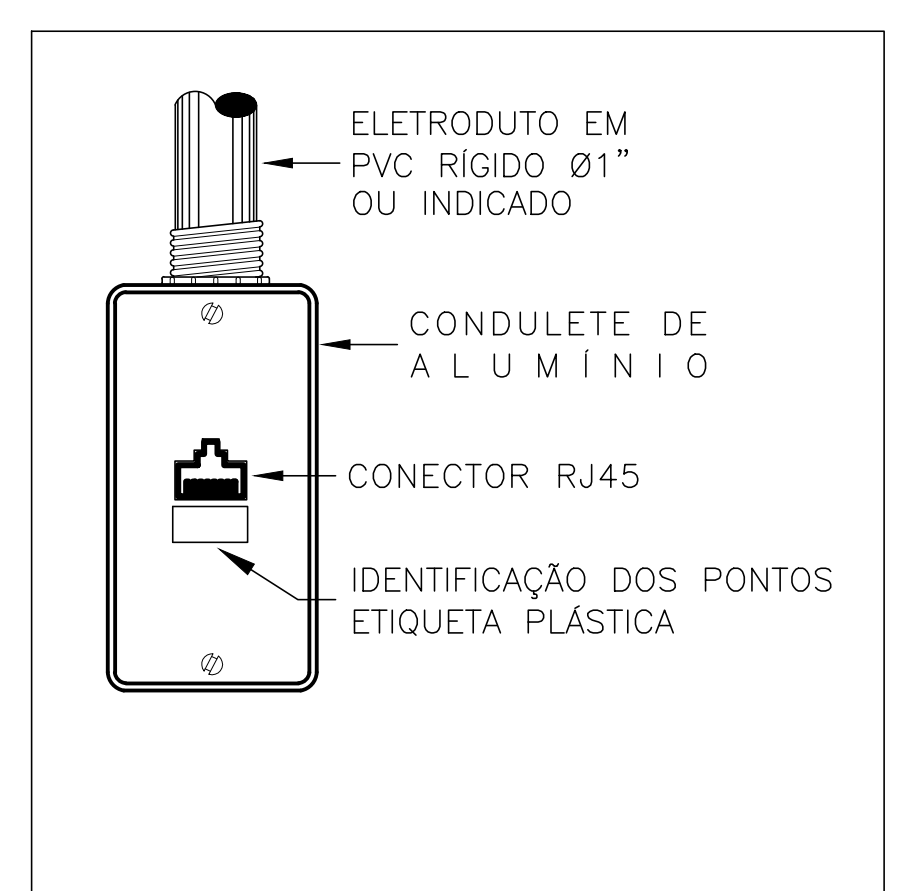
DETALHE TÍPICO: CONDULETE DE ALUMÍNIO REDE ESTRUTURADA - 1 PONTO SEM ESCALA
